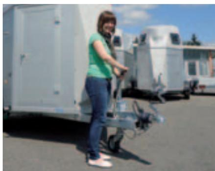
So verfügen nun alle Versionen dieser Modellreihe – gleich ob in der Ausführung mit Holz-, Aluminium- oder Vollpolyesterbordwänden – über einen praktischen Teleskophandbremshebel. Dessen oberer Teil lässt sich bequem ausziehen, so dass die Bedienung der Bremse gerade Frauen noch leichter fallen wird. Selbstverständlich bleibt die gewohnte Bremswirkung der bewährten Auflaufeinrichtung des 2,5-t-Anhängers voll erhalten.
